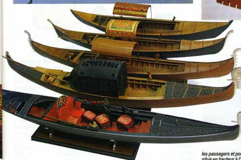
*Malgré les différences évoquées dans cet exposé, on peut grâce à cette vue, noter ce qui s'est maintenu dans la conception de la gondole : coque pointue aux deux bouts, petits ponts avant et arrière, maille des couples, position centrale de la banquette pour les passagers et position du gondolier situé en hauteur à l'arrière gauche.*
