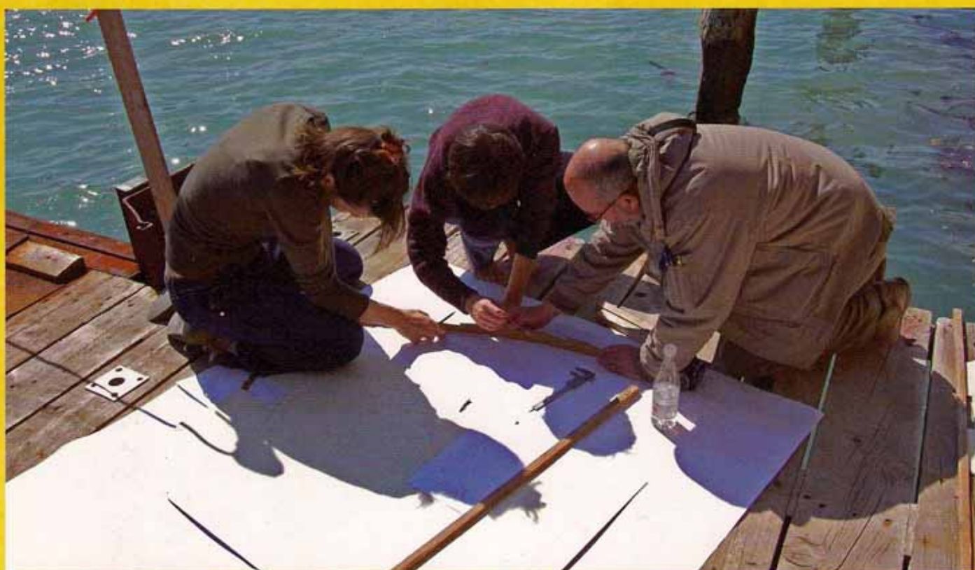
Fig. 8 La tracciatura della sezione maestra sul tavolato del cantiere alle Zattere
