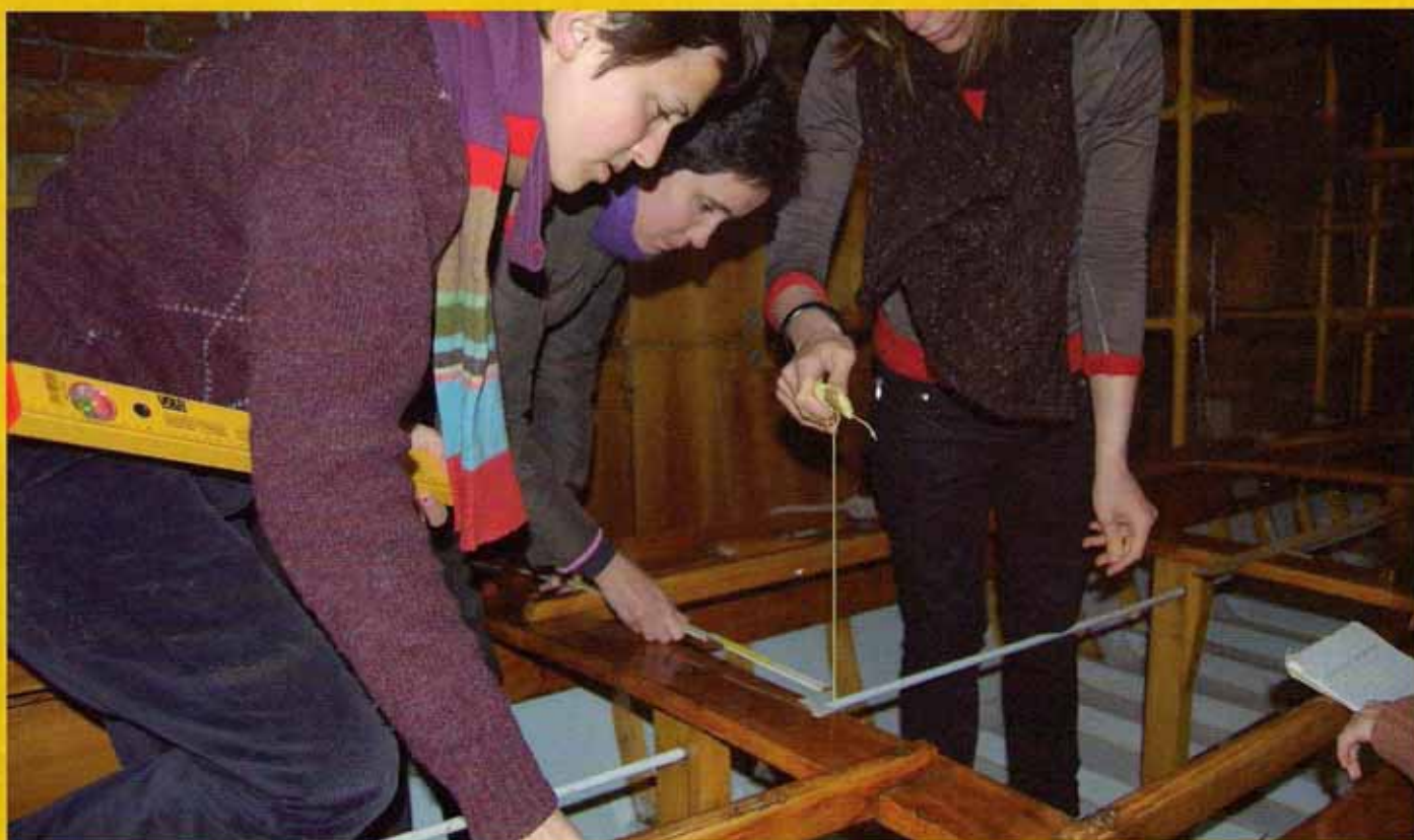
Fig. 8 La tracciatura della sezione maestra sul tavolato del cantiere alle Zattere
