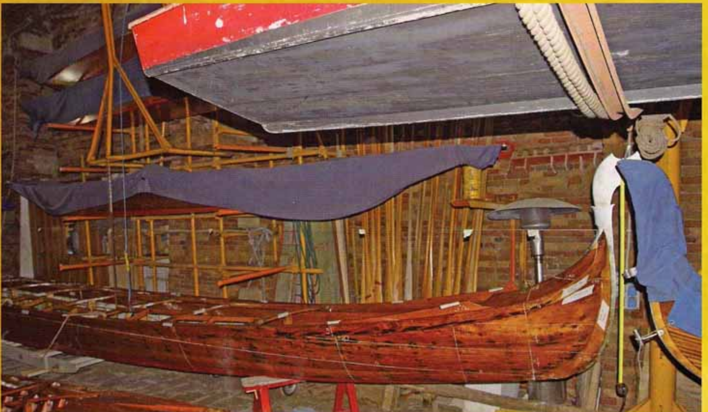
Fig. 2 La parte prodiera della barca con i livelli di riferimento già tracciati.
