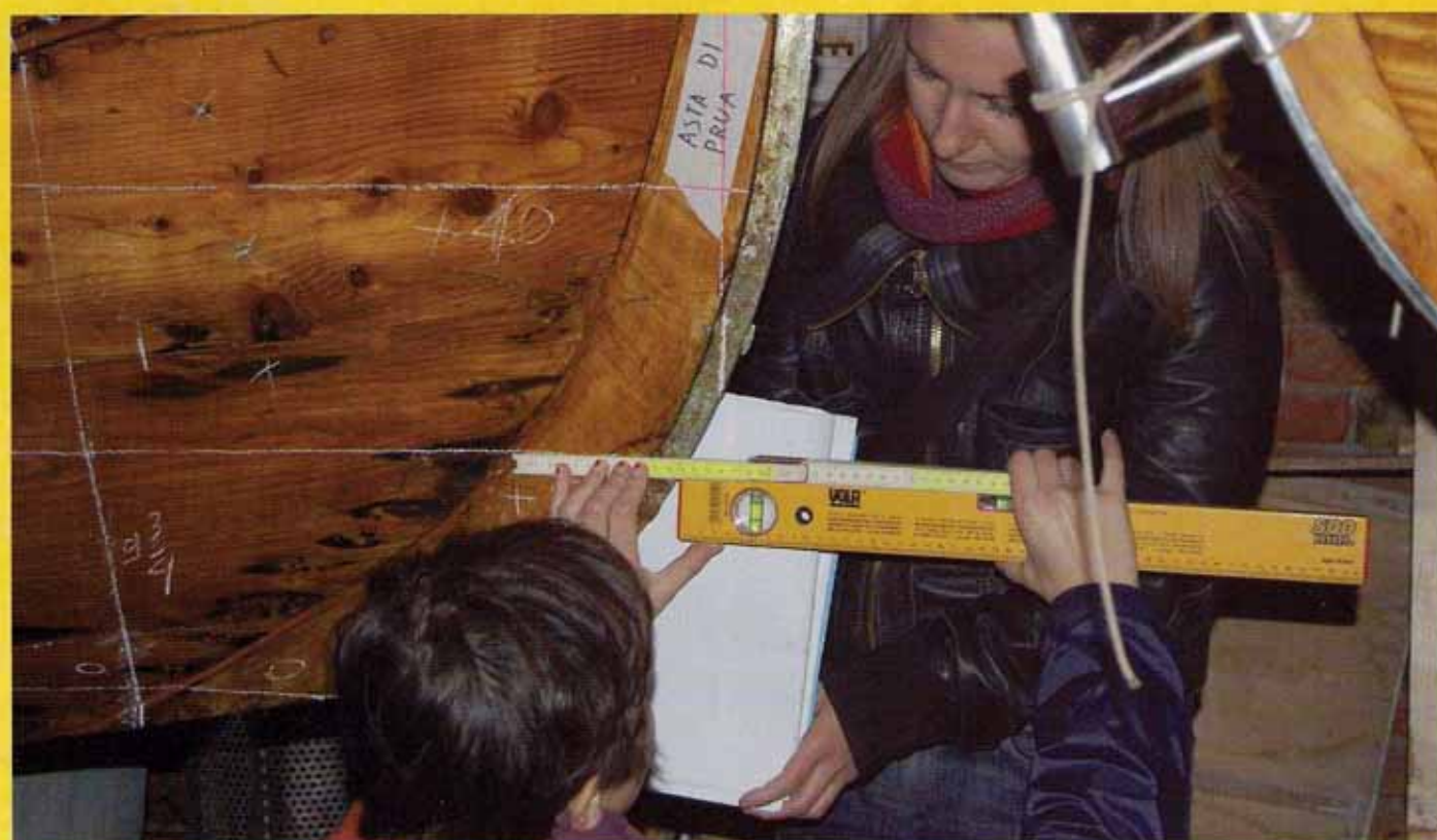
Fig. 4 Due studentesse intente al rilievo della ruota di prua
