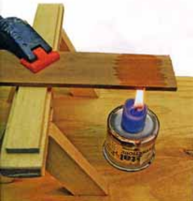
La coque encore fragile est renforcée par des traverses en cerisier pliées au feu de chaque côté.
