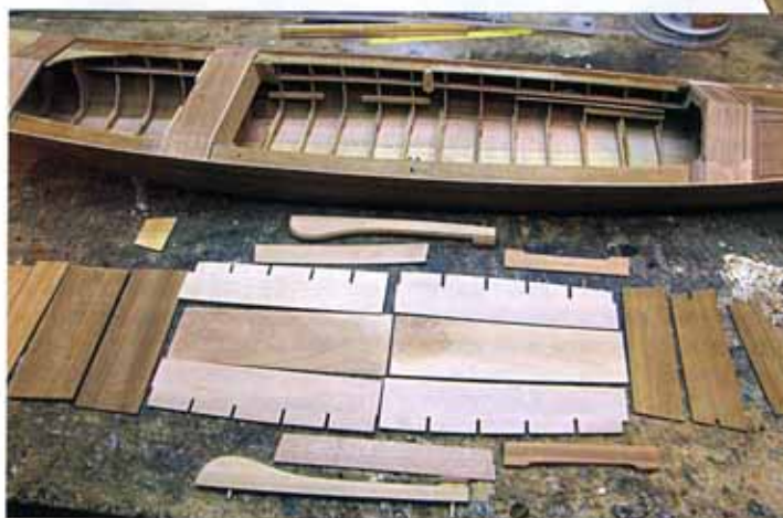
L'accastillage : deux bancs pour l'avant, six planches pour le fond, deux accoudoirs chantournés et un pontage mobile pour l'arrière.
