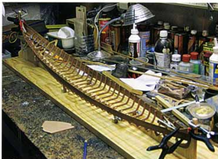
Les sommets des allonges de chaque couple sont sectionnés à 2 mm (au 1/10) sous le can supérieur des bordages.
