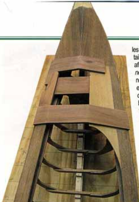
Pont arrière terminé : trois traverses, trou pour la forcole sur le bord droit de la coque.
