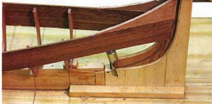
On rajoute à l'avant et à l'arrière des petits morceaux de bordage qui procurent ainsi le profil incurvé propre aux gondoles.
