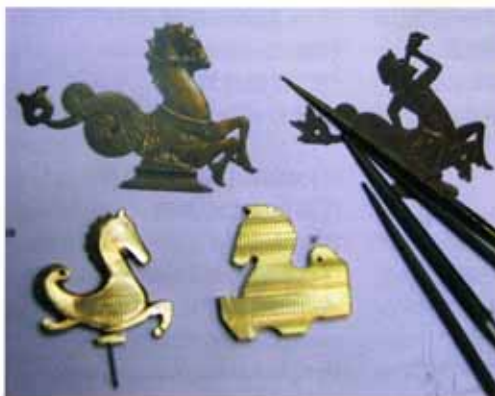
Façonnage des chevaux dans du laiton de 3 mm.
