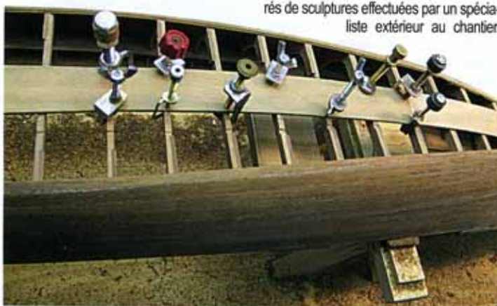
Le fond de la coque (sole) est constitué de six planches.
