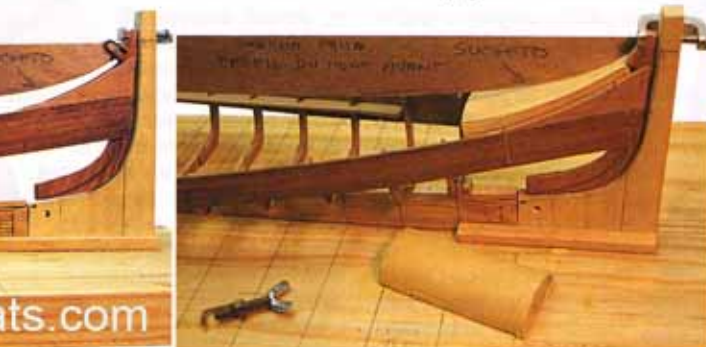
Installation du gros bloc de tilleul (le « sucheto ») à l'avant, après mise en forme à l'herminette.
