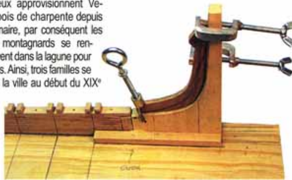
Fixation de l'allonge de proue dans son logement incliné de 10° à droite.
