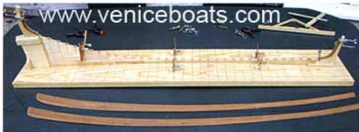
L'ensemble du chantier avec ses 33 paires de petits tasseaux, les deux allonges de proue et de poupe et les trois maître couples. Avec les deux grands bordages, cela fait en tout sept pièces.
