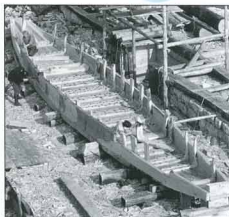
Operazioni di ultimazione della replica del barcone gallo-romano battezzato Atlaripa presso il lago svizzero di Neuchâtel
